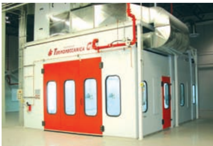
Использование турбинных вентиляторов в камерах Power Therm позволяет разместить агрегатный блок на крыше.
