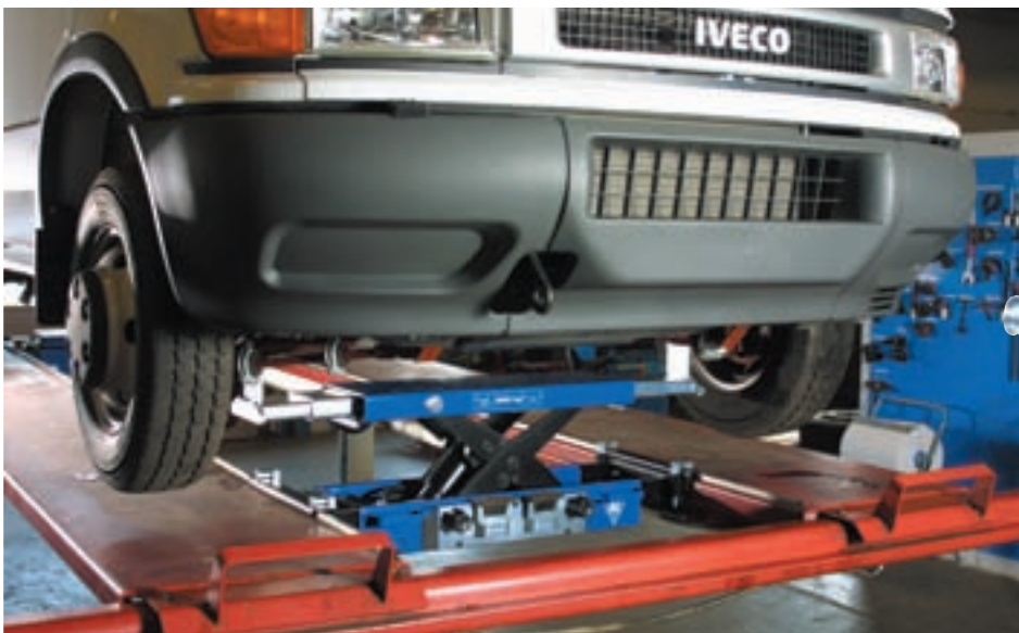
Траверсу грузоподъемностью 2,6 т можно смело использовать для подъема оси коммерческих взнов.
