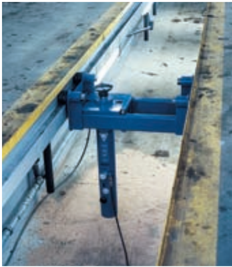
Подвесные канавные домкраты AC Hydraulic отличаются простой конструкцией и относительно небольшой стоимостью.
