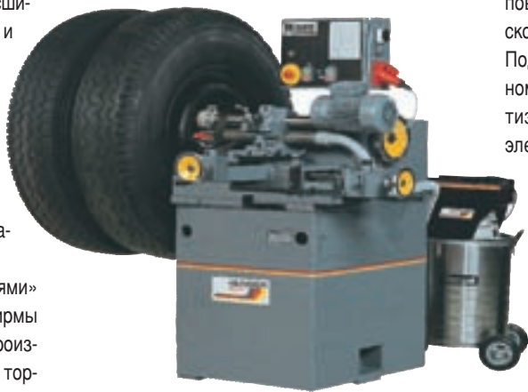
Мощность станка В 325 позволяет протачивать тормозные барабаны в сборе с колесом.
