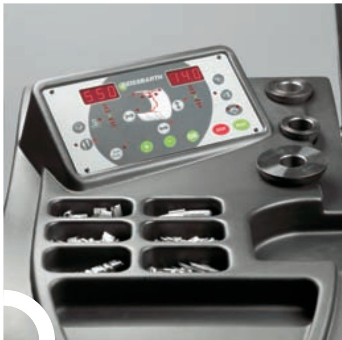
Станки модели MT 835 отличаются двойным цифровым дисплеем с эргономичным пультом управления.
